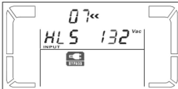
**Parâmetro 2 & 3:** Ajusta os pontos de máxima e mínima tensão para permitir o modo BYPASS, com as opções abaixo, que podem ser ajustadas com as teclas “acima” e “abaixo”:
